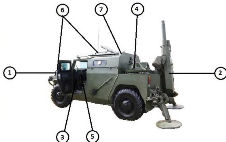
Рисунок 3 – Схема установки минометной системы на боевую технику
